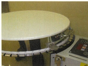
(写真 2) 450°Cから500°Cの間にフタを閉めてください。
