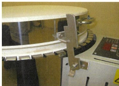
(写真 1) 焼成前に電気炉フタをストッパーで少し開けておきます。
